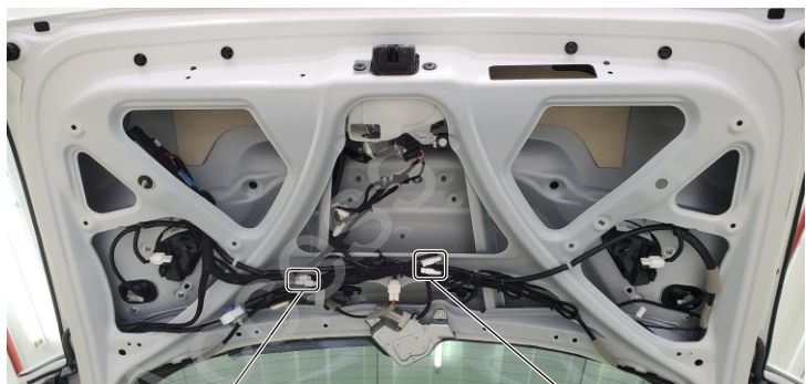
42. 左右两边撑杆电源和撑杆霍尔线束插头对接。
