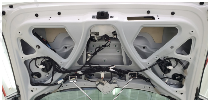
43. 左右两边防夹条线束插头对接。
